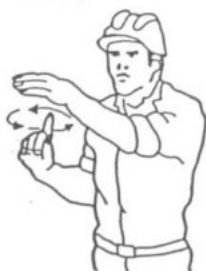
3 Levantar la carga lentamente
